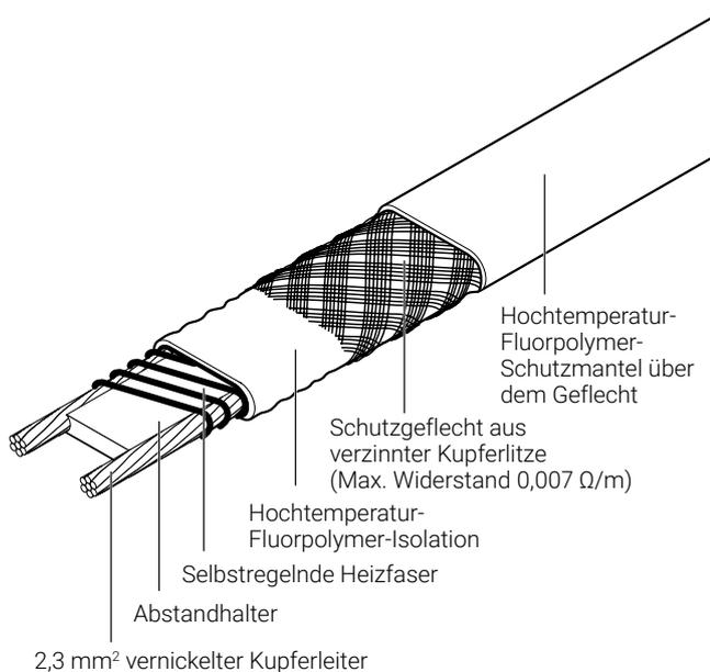
Elektrische Beheizung für Anwendungen zum Halten der Prozesstemperaturen bis zu 150 °C, die der Dampfspülung ausgesetzt werden können.
